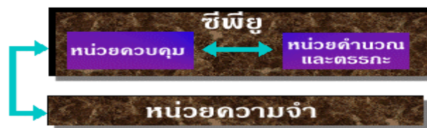
ภาพที่ 3.29 ส่วนประกอบของไมโครโพรเซสเซอร์
